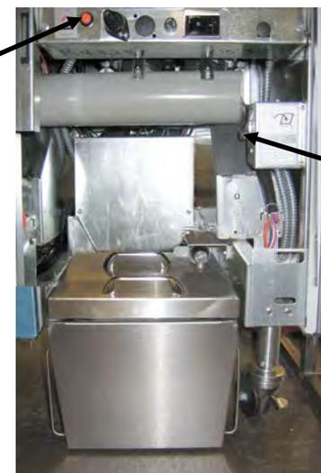
Interruptor de encendido del fundidor.
