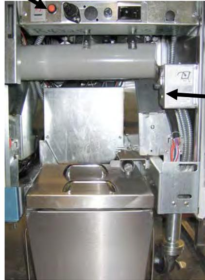
Interruptor de encendido del fundidor
