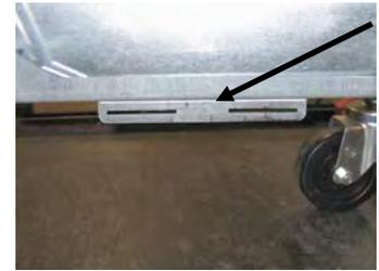
**Figura 1:** Coloque el soporte de alineación en la parte inferior del refuerzo de la caja ATO.
