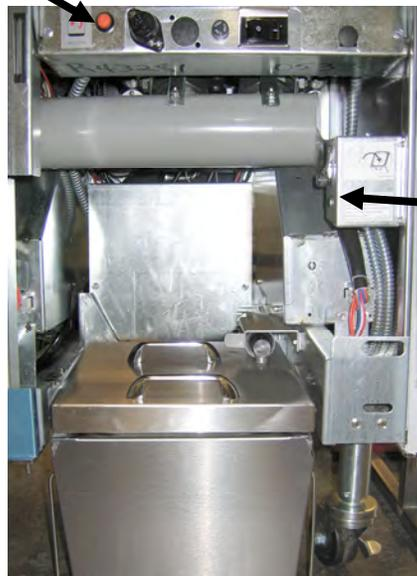
Interruptor de encendido del fundidor
