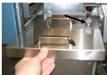
Figure 4 : Placer le couvercle sur le bac et glisser le tube d'aspiration d'huile vers la prise d'aspiration.
