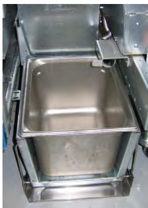
Figure 3 : Insérer le bac intérieur du réservoir d'huile dans le dispositif de fonte.
