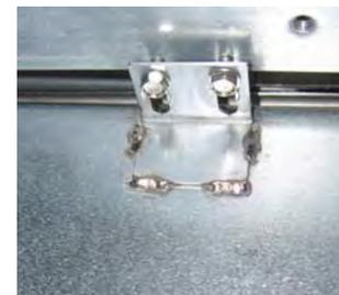
**Figure 5 :** Fixer le dispositif de fonte sur les rails des deux côtés.
