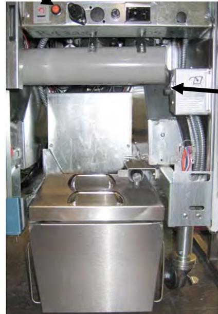
Interrupteur d'alimentation du dispositif de fonte
