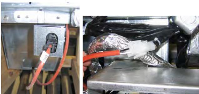
**Figure 6 :** Fixer les connecteurs blancs à deux broches et brancher le connecteur noir dans la boîte de connexion comme illustré. \* **Noter que le raccord noir peut différer de la photo.**
