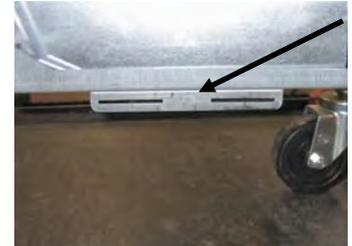
**Figure 1 :** Fixer le support d'alignement au bas du renfort de boîtier ATO.
