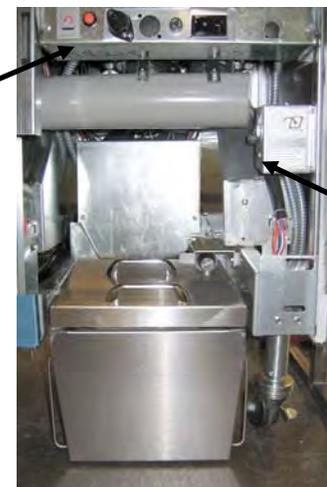
**Figure 7 :** Le dispositif de fonte assemblé est illustré en place.
