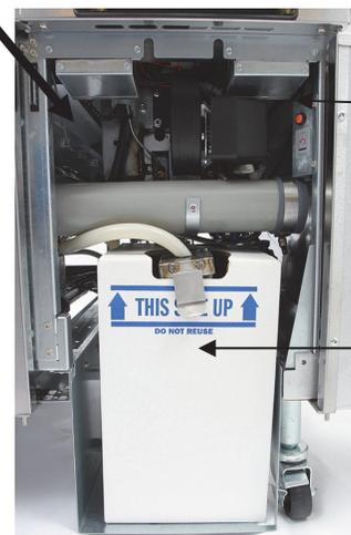
**E** : Récipient d'huile/shortening : Contient l'huile/shortening pour le système d'appoint automatique. Il n'est pas utilisé pour remplir les bacs de cuisson, seulement pour maintenir le niveau d'huile. Utiliser seulement de l'huile fraîche dans le système d'appoint.
