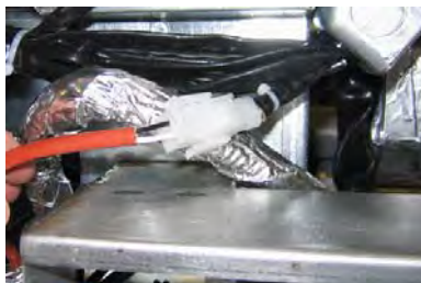
Figure 6 : Fixer les connecteurs blancs à deux broches et brancher le connecteur noir dans la boîte de connexion comme illustré. * Noter que le raccord noir peut différer de la photo.
