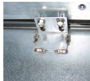
Figure 5 : Fixer le dispositif de fonte sur les rails des deux côtés.
