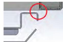
3. Soulever/lever les pinces de blocage pour retirer les diffuseurs d'air et/ou les joints de barquette.
