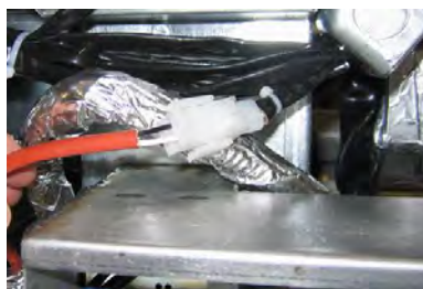
Afbeelding 6: Bevestig de twee-pens witte aansluitingen en steek de zwarte aansluiting in de doos zoals aangegeven. * Merk op dat de positie van de zwarte connector kan verschillen van de positie op de foto.
