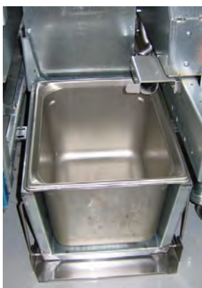
Afbeelding 3: Plaats de interne oliereservoirpan in de smelter.
