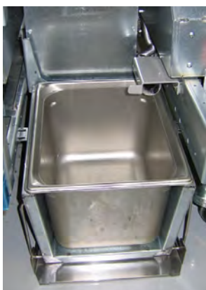
Afbeelding 3: Plaats de interne oliereservoirpan in de smelter.
