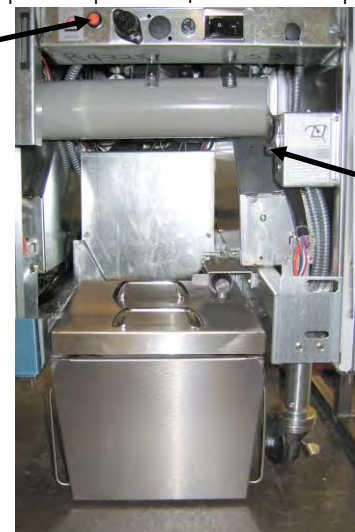
Рис. 7. Собранное устройство для растапливания жира показано установленным в требуемом месте.
