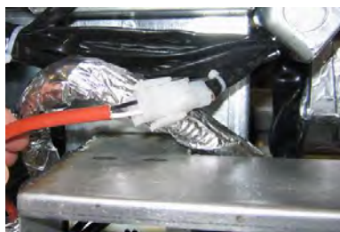
Рис. 6. Прикрепите белые двухштырьковые соединители и вставьте черный соединитель во вспомогательный блок, см. рис. *Обратите внимание: расположение черного соединителя может отличаться от показанного на фотографии.
