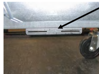
Рис. 1. Прикрепите юстировочный кронштейн к нижней стороне скобы блока автоматической подпиточной системы.
