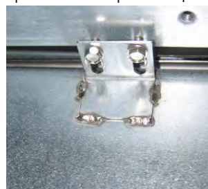
Рис. 5. Прикрепите устройство растапливания жира к направляющим с обеих сторон.
