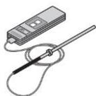
Пирометр с зондом для измерений на поверхности гриля
