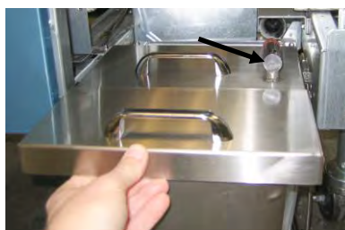
Figura 4: Collocare il coperchio sulla coppa e inserire il tubo di aspirazione dell'olio nella presa di aspirazione femmina.
