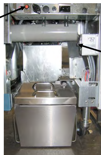
Figura 7: L'unità di scioglimento è mostrata in posizione.
