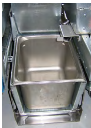
Figura 3: Inserire la coppa interna dell'olio nell'unità di aspirazione.
