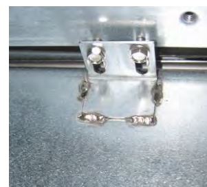
Figura 5: Collegare l'unità di scioglimento alle rotaie su entrambi i lati.
