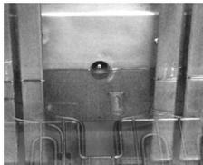
Accertarsi che la friggitrice sia ACCESA. Controllare la temperatura dell'olio premendo il pulsante della temperatura. La temperatura dell'olio deve essere superiore agli 82 °C (180 °F).
