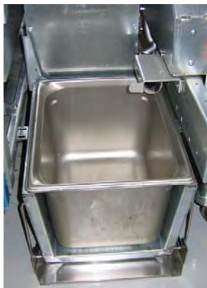
**Slika 3:** Stavite sud unutarnjeg spremnika za ulje u uređaj za taljenje.
