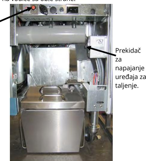
**Slika 7:** Prikazan je montiran uređaj za taljenje.
