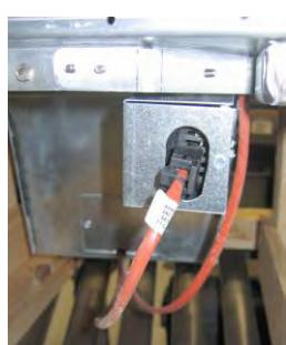
**Slika 6:** Zakačite dvoigličaste bijele konektore i stavite crni konektor u uslužni okvir kako je prikazano. \* Položaj crnog spoja se može razlikovati od prikazanog na slici.
