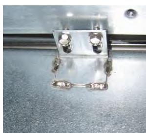
**Slika 5:** Zakačite uređaj za taljenje na vođice sa obje strane.
