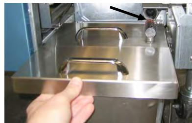
**Slika 4:** Stavite poklopac uređaja za taljenje na uređaj i gurnite istureni dio cijevi za ulje u usisni priključak.
