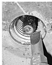
Očistite naslage oko AIF i ATO senzora (kod svih friteza). Koristite odvijač ili drugi sličan predmet kojim se možete približiti dijelu sa sondom. Pazite da ne oštetite sondu.
