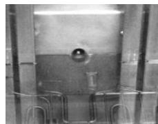
Neka friteza bude UKLJUČENA. Provjerite temperaturu ulja pritiskom na tipku za temperaturu. Temperatura ulje bi trebalo da bude iznad 82 °C (180 °F).
