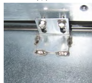
Rysunek 5: Zamontuj urządzenie do topienia do szyn po obu stronach.
