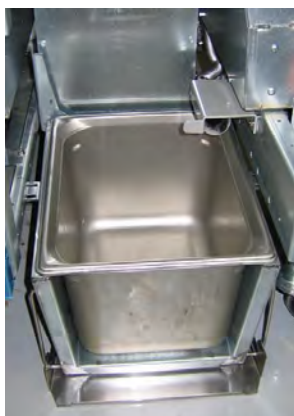
Rysunek 3: Włóż wewnętrzną miskę zbiornika oleju do urządzenia do topienia.
