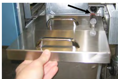
Rysunek 4: Umieść pokrywę na misce i przesuń złączkę rury wlotowej oleju w żeńskie gniazdo ssące.
