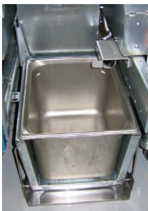
Hình 3: Lắp thùng dự trữ dầu bên trong vào bộ phận nấu chảy dầu.
