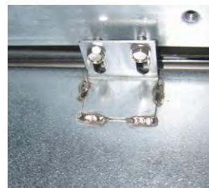
Hình 5: Lắp bộ phận nấu chảy dầu vào thanh giằng ở cả hai bên.
