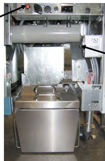
Hình 7: Bộ phận nấu chảy dầu hiển thị đã được lắp đặt đúng vị trí.
