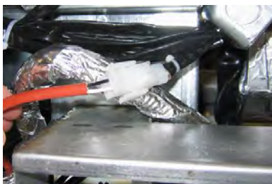
Hình 6: Cắm giắc nối 2 chân màu trắng và giắc cắm màu đen vào hộp như chỉ dẫn. * Lưu ý vị trí khớp nối đen có thể khác với hình ảnh.
