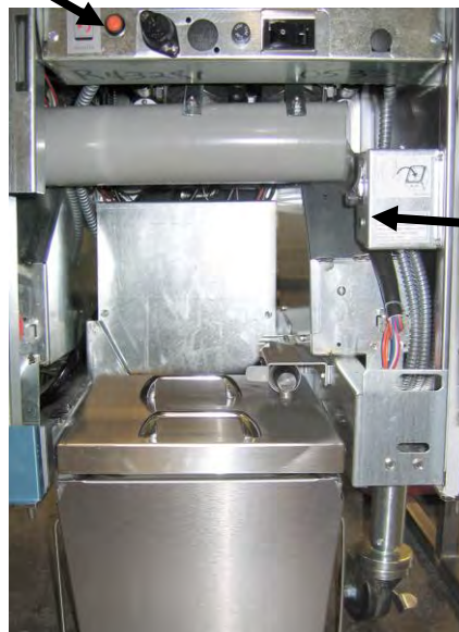
Công tắc điện của bộ phận nấu chảy dầu
