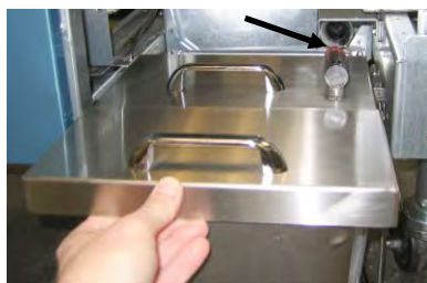
Hình 4: Đẩy nắp thùng và lắp đầu nối ống dẫn dầu vào khớp nối âm.
