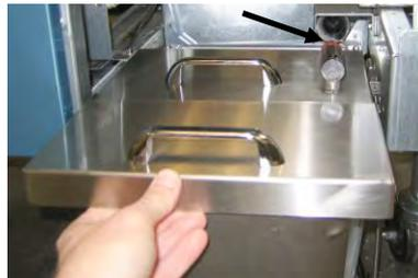
**Figura 4:** Coloque a tampa da bandeja e deslize o tubo de recolha de óleo na tomada fêmea de sucção.
