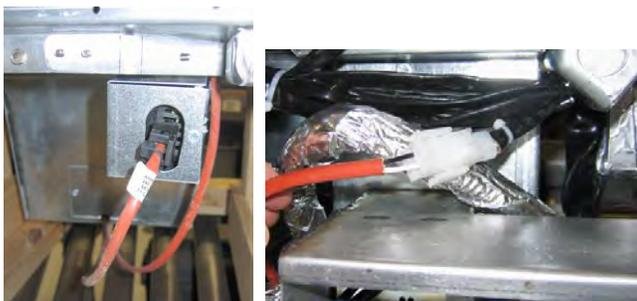
**Figura 6:** Monte os conectores brancos de dois pinos e ligue o conector preto à caixa de ferramentas. \* Note que a posição da ligação preta pode diferir da foto.
