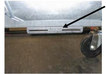
**Figura 1:** Fixe o suporte de alinhamento à parte traseira do gancho da caixa ATO.
