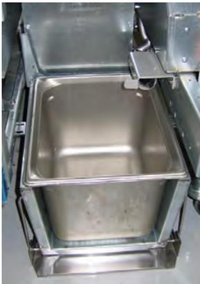
**Figura 3:** Insira a bandeja interior do reservatório de óleo na unidade de fusão.
