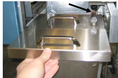
Kuva 4: Aseta kansi pannuun ja liu'uta öljyn liitinputki naarasimuliittimeen.
