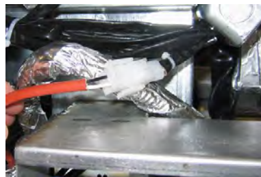
Kuva 6: Liitä kaksineulaiset valkoiset liittimet ja kiinnitä musta liitin esitetyllä tavalla pistorasiaan. * Huomaa, että musta liitäntä saattaa erota kuvasta.
