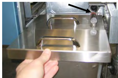
Obrázok 4: Nasadte veko na plech a zasuňte hadicu na nasávanie oleja do objímky s otvorom.
