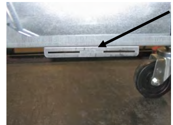
Obrázok 1: Pripevnite zarovnávaciu konzolu k spodnej časti rozpery schránky ATO.
