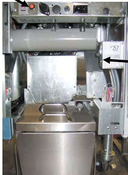
Hlavný vypínač rozpúšťacej jednotky
