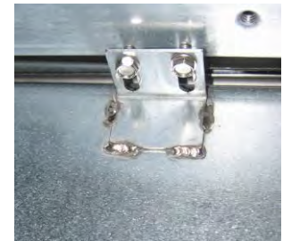
Obrázok 5: Pripojte rozpúšťaciu jednotku k lištám na oboch stranách.
