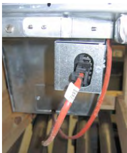
Obrázok 6: Pripojte dvojkoľkové biele konektory a zasuňte čierny konektor do skrinky inžinierskych sietí podľa obrázka.
