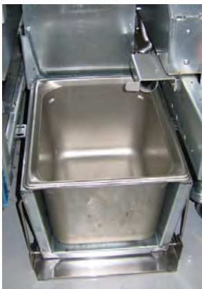
Obrázok 3: Vložte plech vnútorného zásobníka oleja do rozpúšťacej jednotky.
