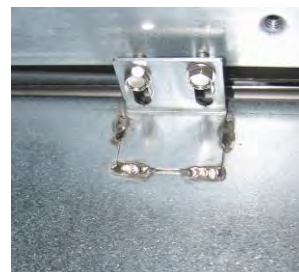
Slika 5: Pritrdite talilno enoto v vodila na obeh straneh.
