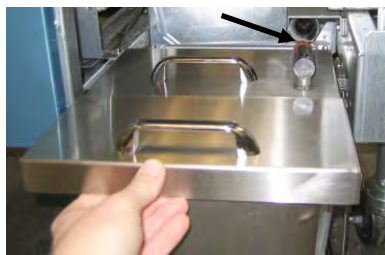
Slika 4: Namestite pokrov kozice in premaknite sesalno oljno cev v žensko sesalno vtičnico.
