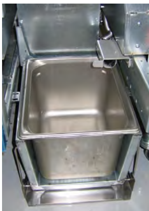
Slika 3: Vstavite notranji oljni rezervoar v talilno enoto.
