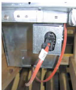
Slika 6: Na zadnji strani talilne naprave pritrdite bele dvovrstne priključke in vtaknite črni priključek na ohišje vtičnice, kot je prikazano. * Upoštevajte, da položaj črnega priključka lahko odstopa od fotografije.
