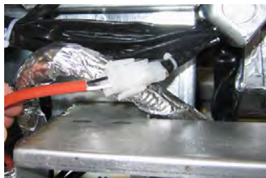
Slika 6: Na zadnji strani talilne naprave pritrdite bele dvovrstne priključke in vtaknite črni priključek na ohišje vtičnice, kot je prikazano. * Upoštevajte, da položaj črnega priključka lahko odstopa od fotografije.
