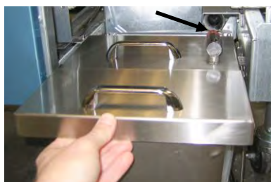
Obrázek 4: Položte víko na nádobu a zasuňte spojku sací trubky oleje do protikusu.
