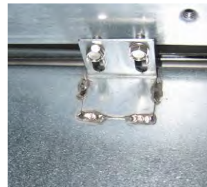
Obrázek 5: Upevněte rozpouštěč ke kolejnicím na obou stranách.
