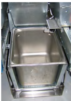
Obrázek 3: Vložte do rozpouštěče vnitřní zásobník oleje.
