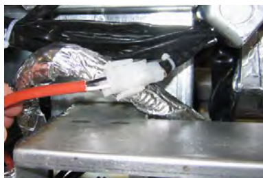
Obrázek 6: Propojte dvoukolíkové bílé konektory a zapojte černý konektor do elektroinstalační krabice podle vyobrazení. * Poloha černého konektoru se může lišit od vyobrazení na fotografii.
