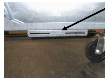
Obrázek 1: Upevněte montážní držák k dolní straně vzpěry skříně ATO.
