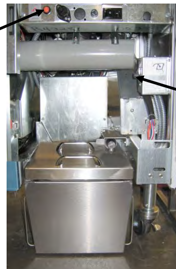
Figur 7: Den monterade smältenheten visas på sin plats.
