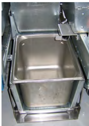
Figur 3: Sätt i den inre oljebehållaren i smältenheten.
