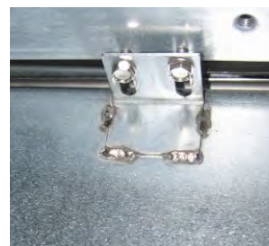
Figur 5: Fäst smältenheten i skenorna på båda sidor.
