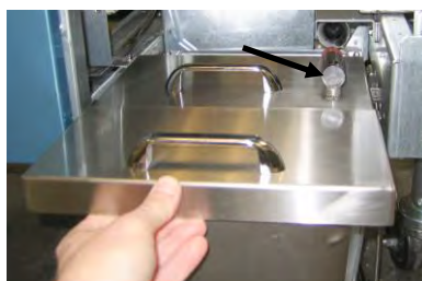
Εικόνα 4: Τοποθετήστε το καπάκι στο ταψί και ωθήστε τον σωλήνα αναρρόφησης λαδιού εντός της θηλυκής υποδοχής αναρρόφησης.
