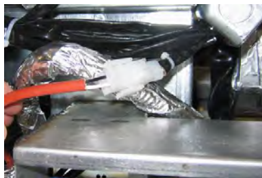
Εικόνα 6: Προσαρτήστε τους λευκούς συνδέσμους δύο ακίδων και συνδέστε τον μαύρο σύνδεσμο στο κουτί συνδέσεων, όπως στην εικόνα.
