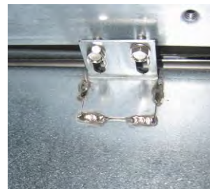
Εικόνα 5: Προσαρτήστε τη μονάδα τήξης στις ράγες και στις δύο πλευρές.
