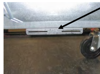
Εικόνα 1: Προσαρτήστε τον βραχίονα ευθυγράμμισης στο κάτω μέρος του στηρίγματος του κουτιού ΑΤΟ.
