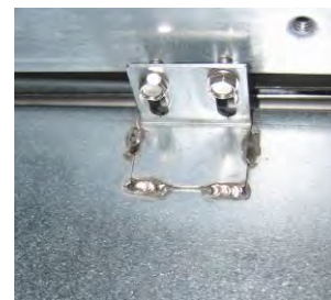
Слика 5: Закачите уређај за топлeње на шине са обе стране.
