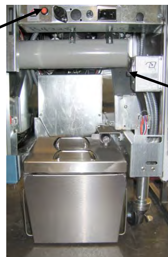
Слика 7: Монтирани уређај за топлeње је приказан у положају.
