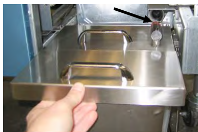
Слика 4: Ставите поклопац на лонац и уметните цев за прикупљање уља у отвор усисног прикључка.
