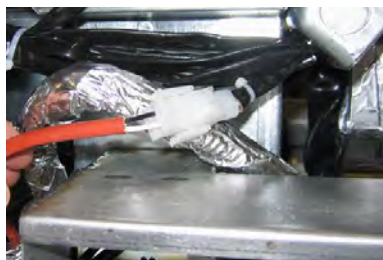
Слика 6: Закачите двоигличасте беле конекторе и уметните црни конектор у комуналну кутију како је приказано.
