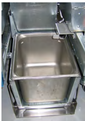
Слика 3: Ставите лонац унутрашњег резервоара за уље у уређај за топлeње.
