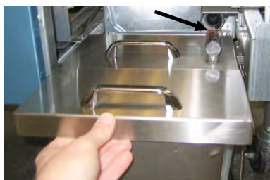
Figur 4: Placera locket på behållaren och skjut fast oljeupptagningsslangen på suganslutningen.
