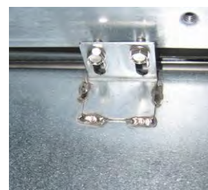
Figur 5: Fäst smältenheten i skenorerna på båda sidor.
