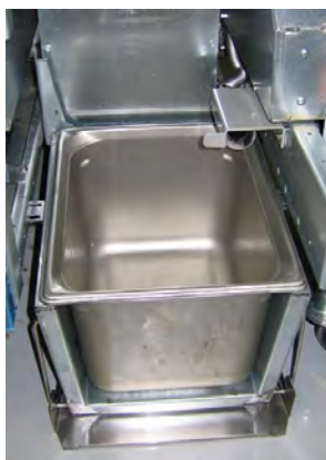
Figur 3: Sätt i den inre oljebehållaren i smältenheten.
