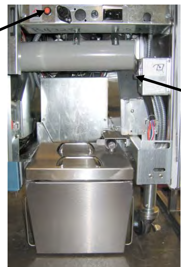
Kuva 7: Koottu sulatusyksikkö näytetään kuvassa sen ollessa paikoillaan.
