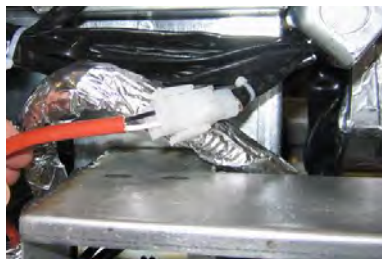
Kuva 6: Liitä kaksinapaiset valkeat liittimet ja kytke musta liitin pistorasiaan, kuten kuvassa. * Huomaa mustan liitännän asento voi olla erilainen kuin kuvassa.
