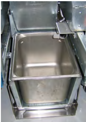
Kuva 3: Aseta sisäinen öljyvarastopannu sulatusyksikköön.
