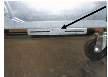
Kuva 1: Liitä kohdistuskiinnitin ATO-laatikon tuen pohjaan.
