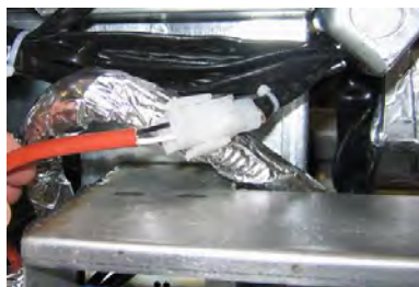
Figur 6: Forbind de tobenede hvide stikforbindelser, og tilslut det sorte stik til stikkontakten som vist. *Bemærk, at placeringen af det sorte stik kan afvige fra billedet.
