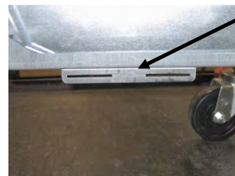
Figur 1: Montér justeringsbeslaget til bunden på ATO-kassebeslaget.
