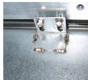
Figur 5: Montér smelteenheden på skinnerne på begge sider.
