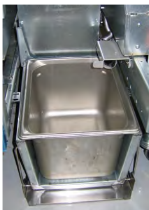
Figur 3: Isæt den indvendige oliebeholderbakke i smelteenheden.
