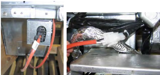
**Figura 6:** Collegare i connettori bianchi a due pin e collegare il connettore nero alla scatola di servizio, come mostrato. **\* Si noti che la posizione del connettore nero potrebbe essere diversa da quella nella foto.**
