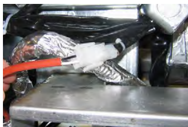
Rysunek 6: Zamontuj i podłącz białe złącza dwustykowe do czarnego złącza w skrzynce uniwersalnej, jak pokazano na rysunku. * Należy zwrócić uwagę, że pozycja czarnego złącza może różnić się od tego na zdjęciu.
