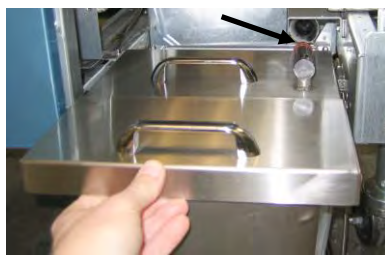
Rysunek 4: Umieść pokrywę na misce i przesunij złączkę rury wlotowej oleju w żeńskie gniazdo ssące.
