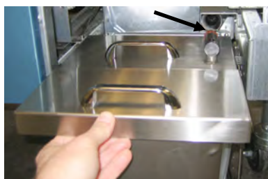
Figura 4: Coloque a tampa na panela e deslize o tubo de coleta de óleo no receptáculo de sucção fêmea.
