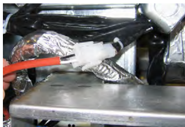
Figura 6: Conecte os conectores brancos de dois pinos e conecte o conector preto na caixa de utilitários, conforme mostrado. * Observe que a posição da conexão preta pode ser diferente da foto.
