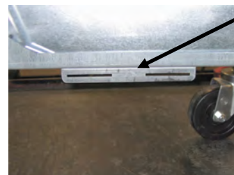
Figura 1: Prenda o suporte de alinhamento na parte inferior do suporte da caixa ATO
