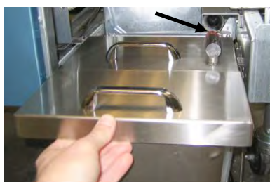
Afbeelding 4: Plaats het deksel op de pan en schuif de olieslang in het vrouwelijke gedeelte van de zuiger.
