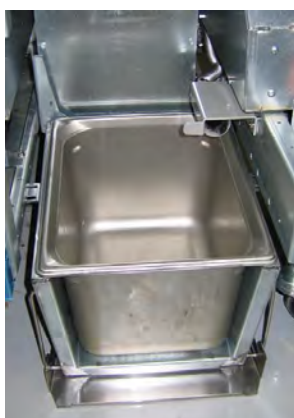
Afbeelding 3: Plaats de interne oliereservoirpan in de smelter.
