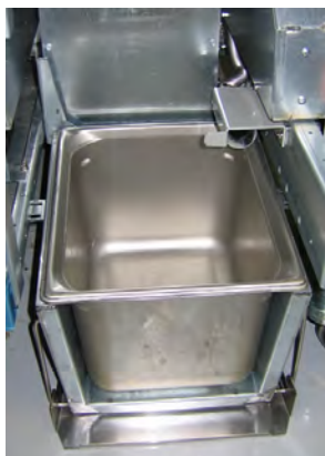
Afbeelding 3: Plaats de interne oliereservoirpan in de smelter.
