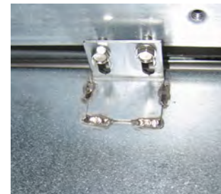
Afbeelding 5: Bevestig de smelter aan beide zijden op de rails.
