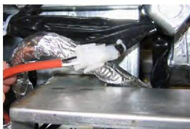
図 6：上の写真の通りに、白い 2 ピンコネクタを取り付け、黒いコネクタをユーティリティボックスに挿し込みます。* 黒い接続部の実際の位置は写真と異なる場合がありますのでご注意ください。
