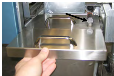
図 4：蓋をパンの上に置き、オイルピックアップチューブをメス型吸引レセプタクルに滑り込ませます。
