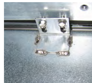
図 5：溶解装置を両側のレールに取り付けます。
