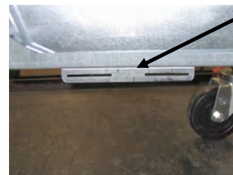
図 1：ATO ボックスブレースの下部にアライメントブラケットを取り付けます。
