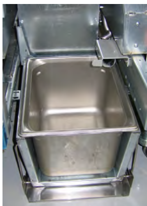
図 3：内部オイル容器パンを溶解装置に入れます。
