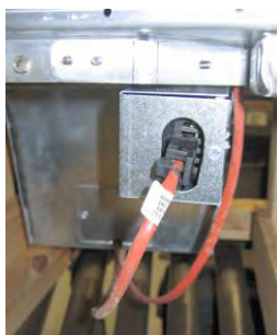
Рис. 6. Прикрепите белые двухштырьковые разъемы и вставьте черный разъем во вспомогательный блок, см. рис. *Обратите внимание: расположение черного разъема может отличаться от показанного на фотографии.
