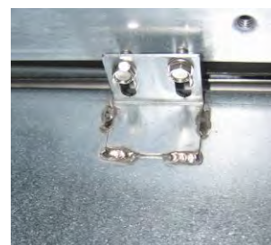
Рис. 5. Прикрепите устройство для растапливания жира к направляющим с обеих сторон.
