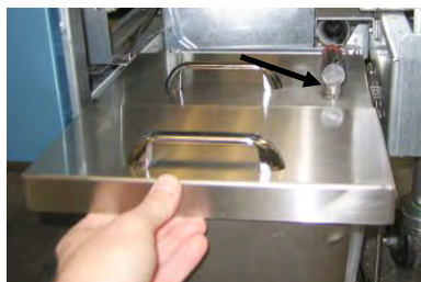
Рис. 4. Установите крышку на устройство для растапливания жира и вдвиньте трубку отбора масла в разъем.
