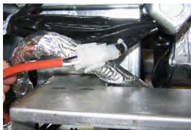
Рис. 6. Прикрепите белые двухштырьковые разъемы и вставьте черный разъем во вспомогательный блок, см. рис. *Обратите внимание: расположение черного разъема может отличаться от показанного на фотографии.
