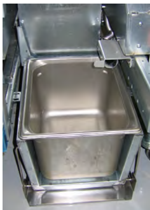
Рис. 3. Вставьте поддон внутреннего бака для масла в устройство для растапливания жира.
