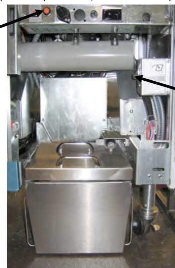
Рис. 7. Собранное устройство для растапливания показано установленным в требуемом месте.
