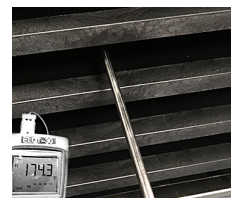
根據高溫計的讀數測試所有加熱板的溫度。
