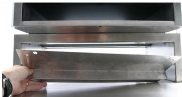
O suporte desliza sob cada lado do gabinete e aparafusa na parte inferior com os parafusos de 1 / 4x20 1" usados no gabinete existente.
