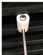
**A extremidade do botão da sonda é colocada contra a placa a ser medida.**
