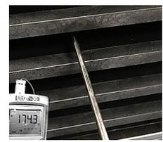
**A temperatura de todas as placas aquecedoras são testadas em comparação com a leitura do pirômetro.**
