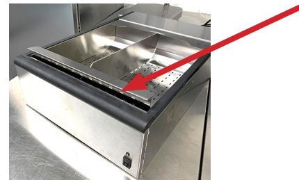
Falsche Platzierung des Speisetabletts. Vorderkante ist zu hoch.
