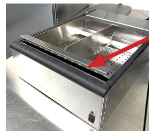
Ubicación incorrecta de la bandeja de comida. El borde delantero está demasiado alto.
