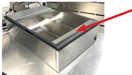
Bac à aliments correctement positionné.
