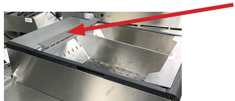
Bac à aliments mal positionné. Bac monté à l'envers.
