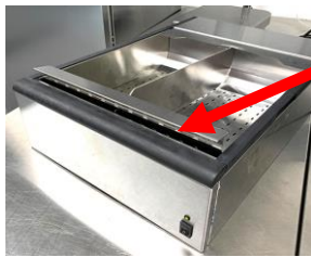
Posizionamento errato del vassoio del cibo. Il bordo anteriore è troppo alto.
