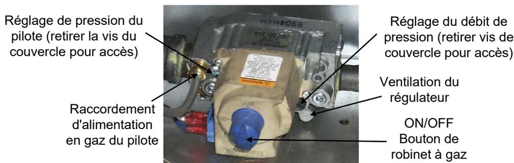
Soupape à gaz non CE typique pour les friteuses avec allumage électronique.
