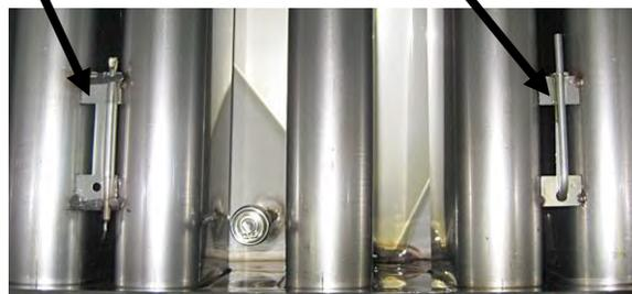
3. Noter la température sur le thermomètre ou le pyromètre. Les mesures réelles de la température et du pyromètre devraient être de  $\pm 3$  °C (5 °F) les uns des autres. Sinon, contacter un centre de service agréé pour obtenir de l'assistance.
