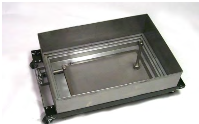
Cestello filtrante a lamelle posizionato correttamente nella coppa del filtro.
