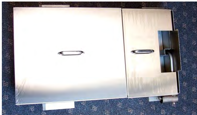
Coperchi posizionati correttamente sulla coppa del filtro.
