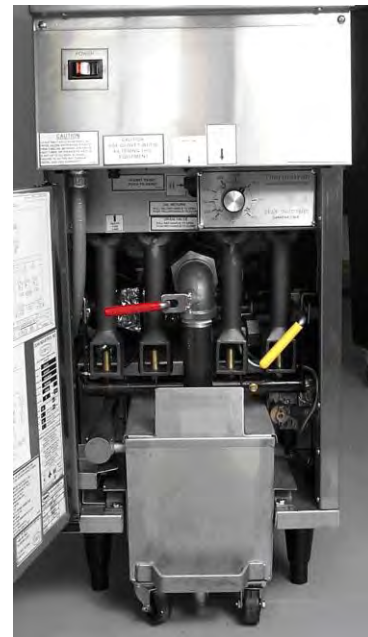
Tipico sistema SUFF (Single Under Fryer Filter) installato in una friggitrice a una vasca.
