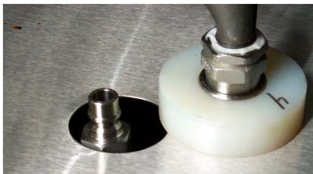
Tubo di prelievo posizionato correttamente nel foro di accesso del coperchio della coppa.
