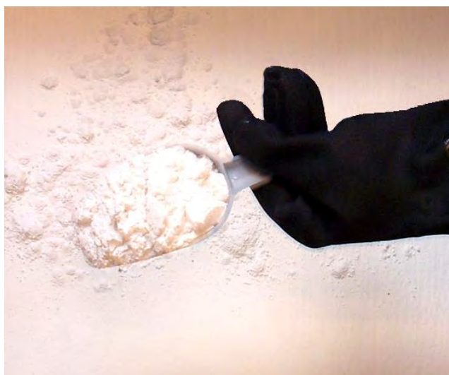
Applicazione di polvere filtrante sulla carta filtrante.
