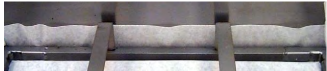
Assicurarsi che la carta filtrante si sovrapponga di 5 cm (2 pollici) su tutti i lati e sia tesa uniformemente sotto l'anello di tenuta.
