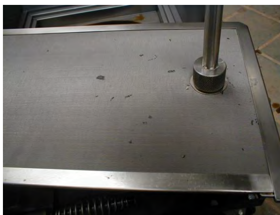
Cestello filtrante a lamelle opzionale utilizzato al posto della carta filtrante.
