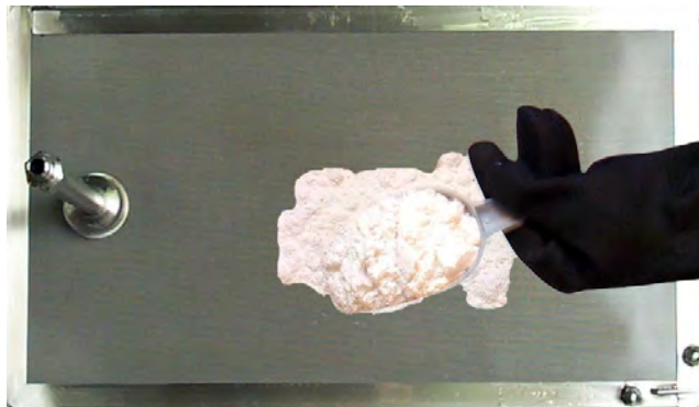
Applicazione della polvere al cestello filtrante a lamelle.
