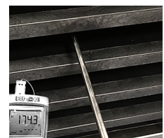
Температурата на всички нагревателни плочи се тества спрямо отчитането на пирометъра.
