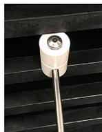
**Gumb na kraju sonde je okrenut prema ploči čija se temperatura mjeri.**
