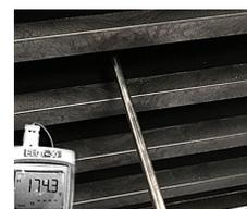
**Temperature svih ploča grijača se testiraju u odnosu na očitavanja pirometra.**
