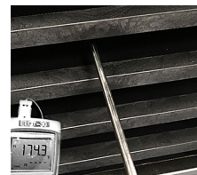
Teplota všetkých vyhrievacích platní sa testuje na základe odčítania pyrometra.
