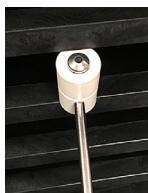
Gombíkový koniec sondy sa umiestni oproti meranej platni.
