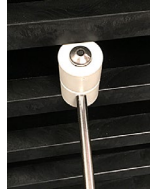
Probu alt ucu ölçülmekte olan plakaya karşı yerleştirilir.
