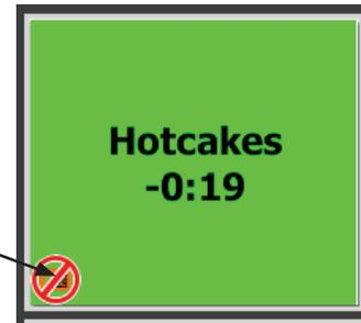
L'icône dans le coin inférieur gauche est affichée si une minuterie est démarrée manuellement sur une armoire munie de la Technologie de suivi de plateau (TTT, Tray Tracing Technology). Si un plateau TTT est inséré, cette icône n'est pas affichée.
